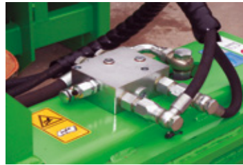
Valvola di massima pressione con circuito rigenerativo Maximum pressure valve with regenerating circuit
